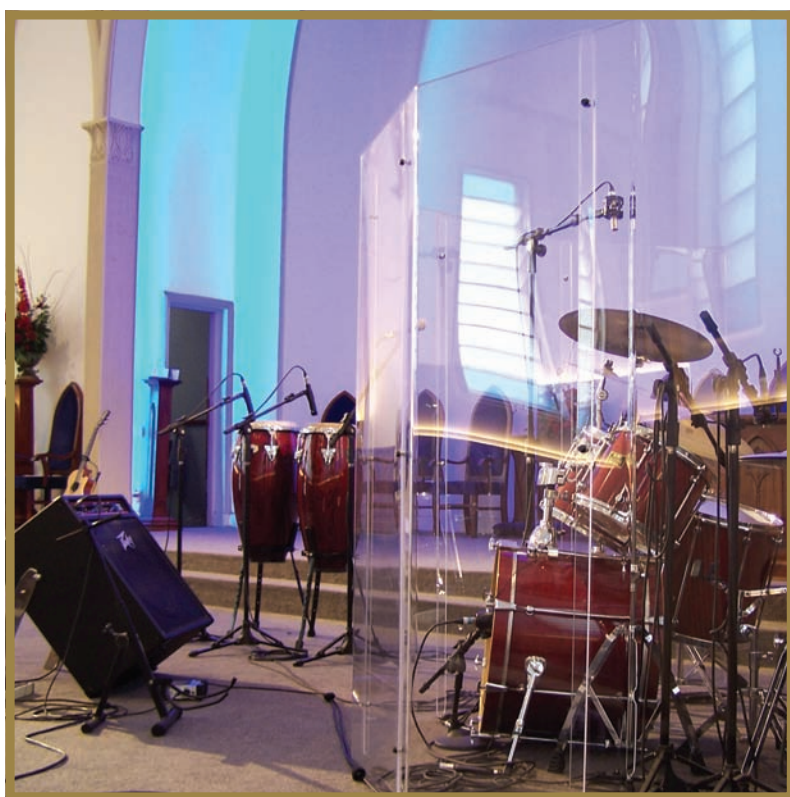
Para reduzir o SPL no campo próximo à bateria, foi utilizado o isolante Isobox, composto por sete placas de acrílico puro cristal de cinco milímetros
